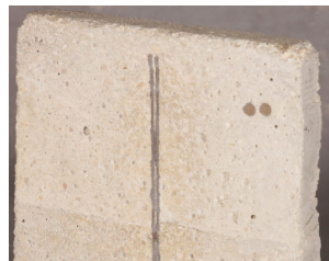
Połączenie dwóch blach AQUAFIN-CJ5 w przekroju betonu.
